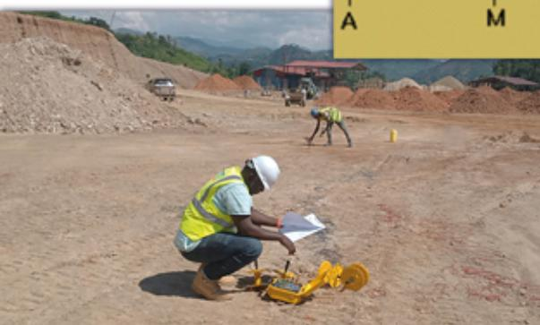
> Rincenc BTP Rwanda a été mandaté pour mesurer la résistivité des sols sur le site de la construction de la sous station Bwishyura proche du lac du Kivu. L'objectif était d'évaluer le potentiel de corrosion du sol et de définir les systèmes de protection cathodiques.
